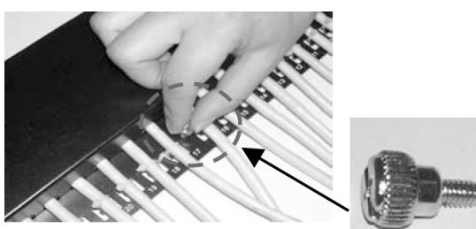
Установите металлическую крышку на место и затяните винты.
